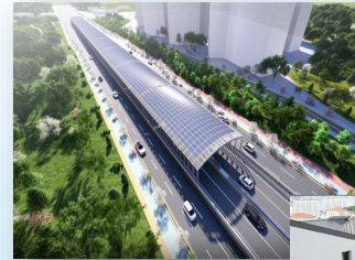
건물, 벽면일체형 태양광 (BIPV, BAPV)
