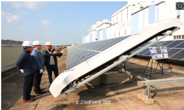
▲동서발전이 당진화력 터빈건물 옥상에 설치된 태양광 모듈에 청소로봇을 장착해 1개월간 실증테스트를 수행했다.
